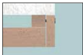
Het afdekken van de holle kamer met eindplaat.
